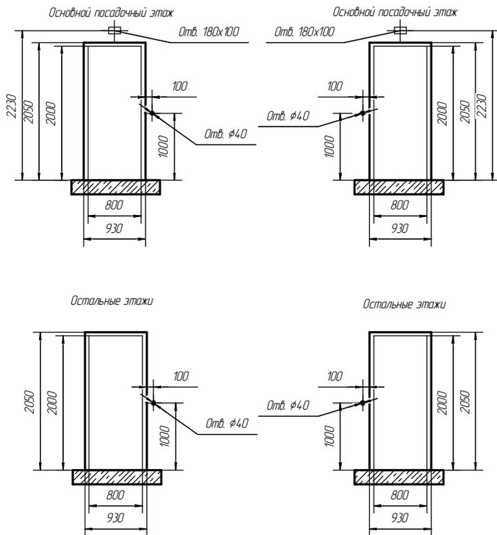
Перечень отверстий в полу машинного помещения
