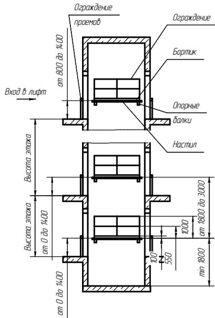
Шахта с высотой этажа от 3000 мм до 5000 мм
